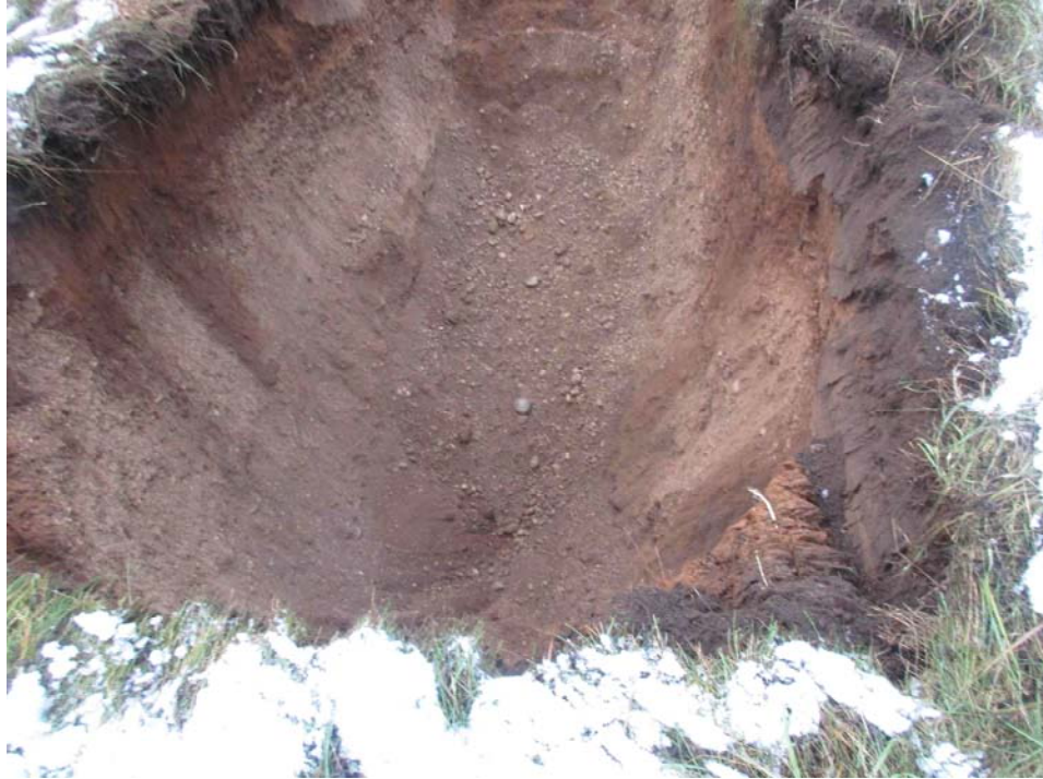
Foto 2-2. Laiavangu II uuringuruumi teenindusosalal kaevandis Ka 5 leviv veeriseline kruus keskmise- ja jämedateralise liivaga.
