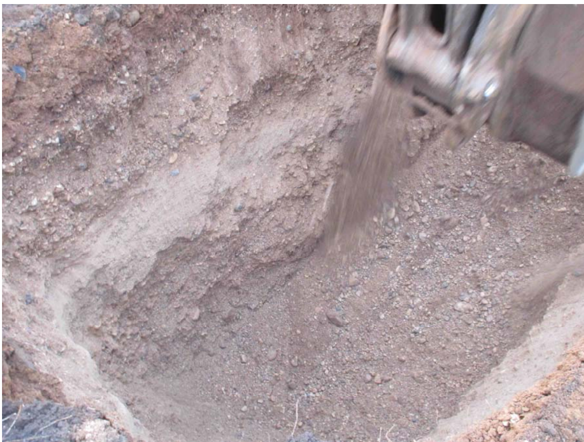
Foto 2-1. Laiavangu II uuringuruumi teenindusalal kaevandis Ka 6 leviv peenveeriseline kruus keskmise- ja jämedateralise liivaga.
