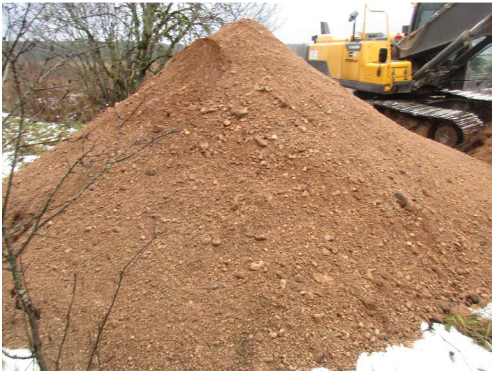
Foto 2-3. Laiavangu II uuringuruumi teenindusala kaguservas kaevandist Ka 8 välja tõstetud veeriseline kruus keskmise- ja jämedateralise liivaga.
